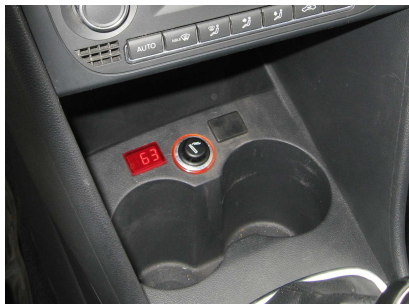
Рисунок 1. Цифровой индикатор температуры.
